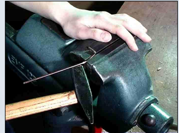
Изготовление крючка из проволоки
